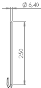
Figura 33 – Haste de fixação da barra superior do suporte do banco de baterias dianteiro
