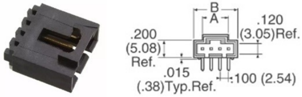
Figura 63 – Conector do sensor de corrente ao BMS
