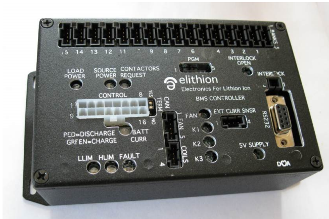
Figura 56 – BMS - Descrição dos LED's e interfaces
